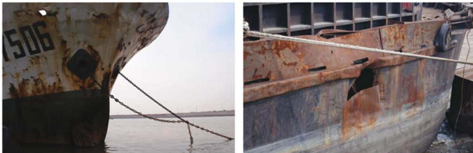
“浙嵊97506”轮与“台联海18”轮船舶碰撞损毁图
